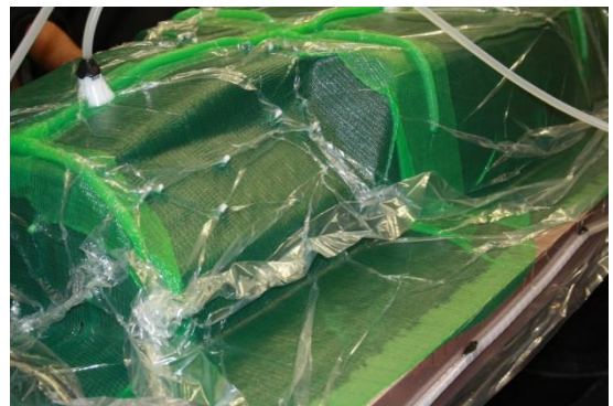
Anwendung des Harzinfusionsverfahrens am Unterschalenwerkzeug
