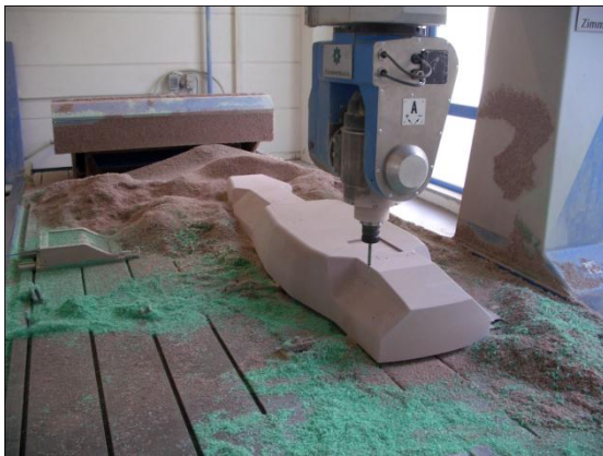
Fräsen des Blockmaterials
