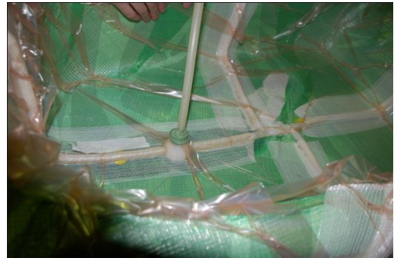
Infusionieren des Harzes
