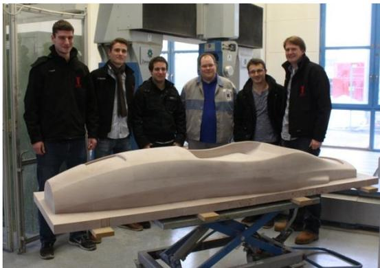
Fräsen der Monocoque-Form bei Kegelmann Technik
