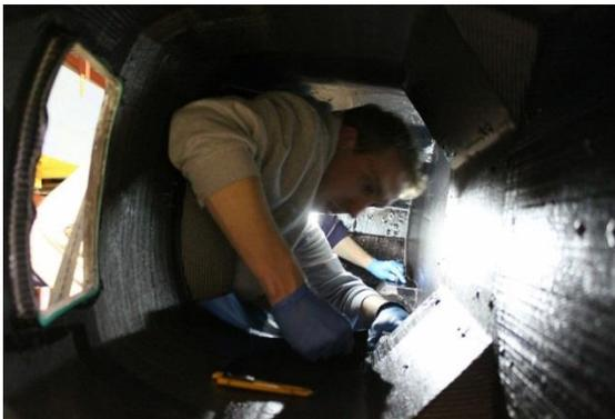
*Fertigung des einteiligen Monocoques*
