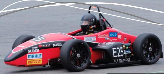
Scrutineerings in den Innenraum des Fahrzeuges hineinpassen. Dadurch wird sichergestellt, dass der Fahrer über ausreichend Platz verfügt und geschützt ist. Im Reglement wird außerdem der Mindestradstand vorgegeben, den wir beim *theta2013* mit 1525 mm genau einhalten werden. Die Entscheidung den Radstand derart zu verkürzen entstand dadurch, dass somit die Länge des Monocoques verkürzt und Gewicht eingespart werden kann. Außerdem erhöht sich die Dynamik des Fahrzeuges auf verwinkelten Kursen.
